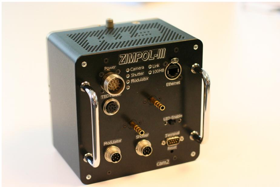
Figura 2.11: Immagine posteriore della camera ZIMPOL-III con i vari connettori.
