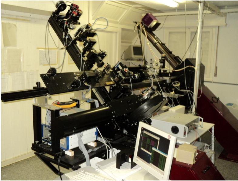
Figura 2.3: Locale osservativo. Scendendo dalla finestra ottica in alto a sinistra si incontra l'ottica di calibrazione, il modulatore di ZIMPOL, una lamina mezz'onda per ruotare il piano di polarizzazione in modo da aumentare l'efficienza dello spettrografo e un derotatore. Sul banco perpendicolare al fascio è installata l'ottica adattiva. Nello sfondo si vede il banco ottico sul quale è installata la camera ZIMPOL dove il fascio luminoso risale dopo essere passato nello spettrografo.
